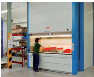
KARDEX. Veľkokapacitný automatizovaný skladovací systém.
